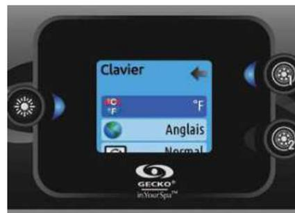
Avec le in.k500 équipé du module sélection de couleur de contour: Si l'option « Rétroéclairage RGB » est activée dans la configuration du spa, une nouvelle option s'affichera pour permettre de choisir la couleur de la lumière du contour.
