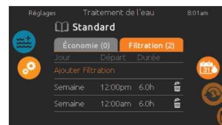
En mode Économie, la valeur de consigne est réduite de 11°C ce qui signifie que le système de chauffage ne démarrera pas sauf si la température descend de 11 °C sous la température à laquelle le spa est réglé.
